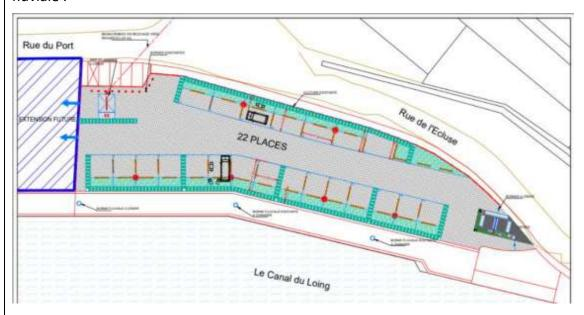
Le projet consiste en la création de 22 places de stationnement pour camping-car, la mise en place de point d'eau, de bornes électriques ainsi que de fosses de vidange.
